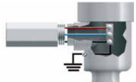
Blau und braun: potentialfreie Kreislaufleitungen Schwarz: Erdanschluss
