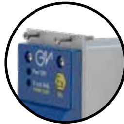
Redundanter Schraubenschalter für Hot Swapping
