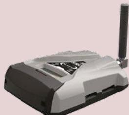
MY2S (MyALARM2 SECURITY) ist ein Fernwirkgerät das autonom oder als Erweiterung für bestehende Überwachungssysteme oder Diebstahlanlagen zum Einsatz kommt. Schnelle Integration und Inbetriebnahme Dank einfacher Installation und Programmierung. Alarmierung durch SMS-Versand oder Sprachmeldung (SIM-Voice), schnelle Alarmannahme, Alarmbestätigung und Rückmeldung mit DTMF-Tonwahl.
