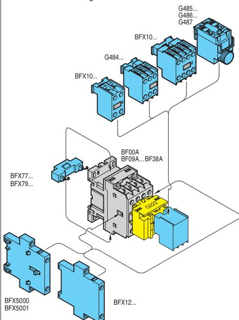
Anbaumöglichkeiten: Einbaulage auf Schützen BF40A...150A, BF40E...BF150E mit montierter mechanischer Verklüpfung G272 oder BFX641
