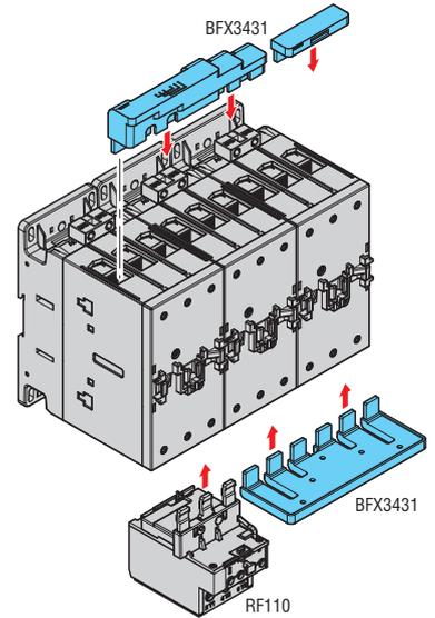
Anschlüsse für Umschalterschütze mit 3-poligen Schützen BF40...BF94
