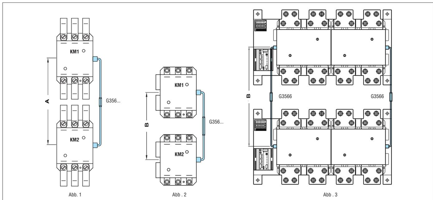
Horizontale und vertikale Verriegelung zwischen Schützen B250...B630
