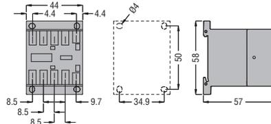
① Empfohlene Bohrung 1,7...2mm
