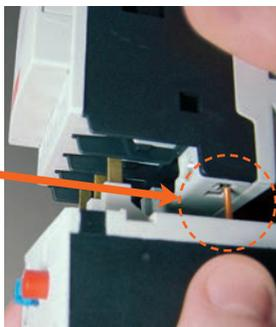
Während das Überstromrelais am Schütz befestigt wird, wird sein Hilfskontakt über einen starren Anschluss an der Klemme der Spule des Schützes befestigt. Durch einen einzigen Vorgang wird die vollständige Befestigung des Relais erreicht, ohne dass andere Anschlüsse nötig sind.
