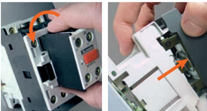
Der Ein- und Ausbau der Hilfskontaktblöcke und des Zubehörs sind einfache, schnelle Vorgänge, die kein Werkzeug erfordern. Dies gilt auch für den Austausch der Spule bei den Schützen BF09...BF38 in AC.
