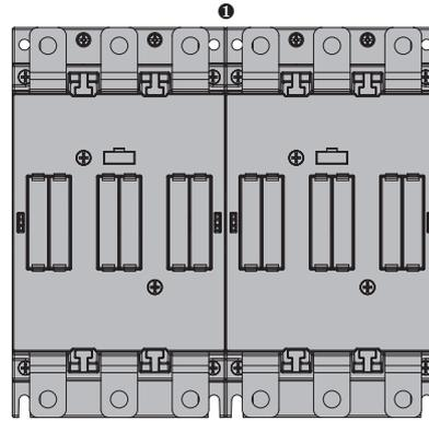
1 Die Verriegelung BFX5500 wird in den 2 Schützen montiert, ohne dass der Platzbedarf zunimmt.
