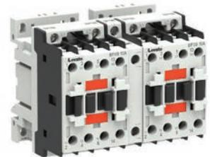
Es sind verschiedene Ausführungen von mechanischen Verriegelungen erhältlich. Eine Version kann in die Schütze von 9 bis 38A integriert werden, ohne dass der Platzbedarf zunimmt. Sie können mit eingebauten Kontakten für die Realisierung der elektrischen Verriegelung ausgestattet sein. Die Verriegelung wird seitlich oder oben an den Schützen montiert.
