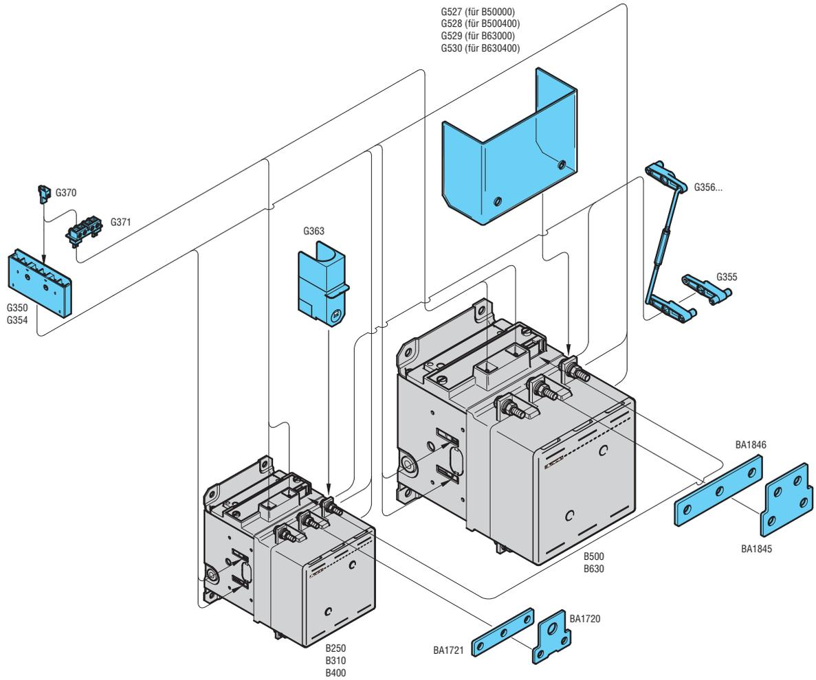
Die Hilfskontaktblöcke vom Typ G350 und G354 können an den Schützen B250...B6301000 mit bis zu maximal 4 Blöcken pro Schütz angebracht werden (insgesamt max. 12 Kontakte).
